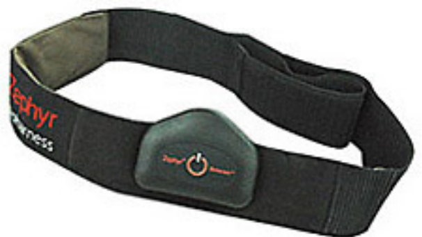
Abb. 2: BioHarness-Gurt zur Messung physiologischer Daten während Belastung
