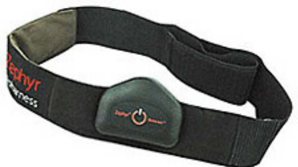
Abb. 2: BioHarness-Gurt zur Messung physiologischer Daten während Belastung
